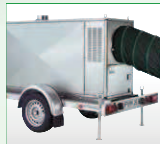
Centrala grzewcza na dopuszczalnej do ruchu przyczepce
